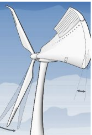
Rotorblätter der Zukunft sollen Klappen wie bei einem Flugzeug bekommen. GRAFIK: SMARTBLADE
